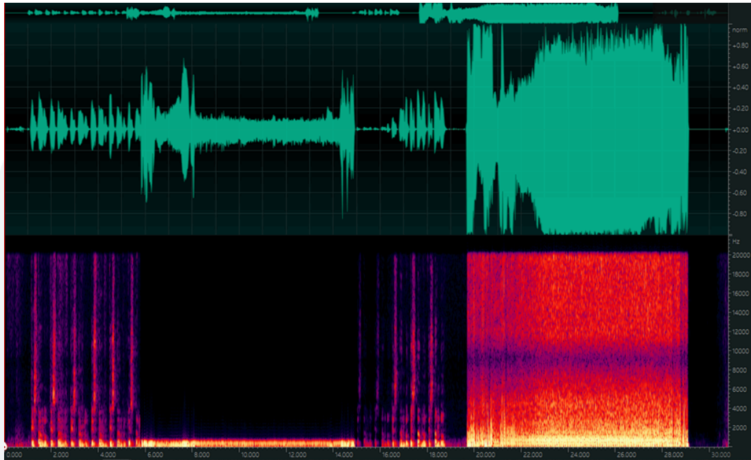
Figura 08 – Mostra resultado após aplicação de filtro passa-baixa (com banda passante limitada a 450 Hz, decaimento em 180 db/década)
